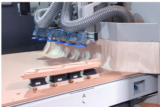
Plaques d'adaptation AP-G avec bloc de bridage par le vide VCBL-B pour le bridage d'une pièce en bois
